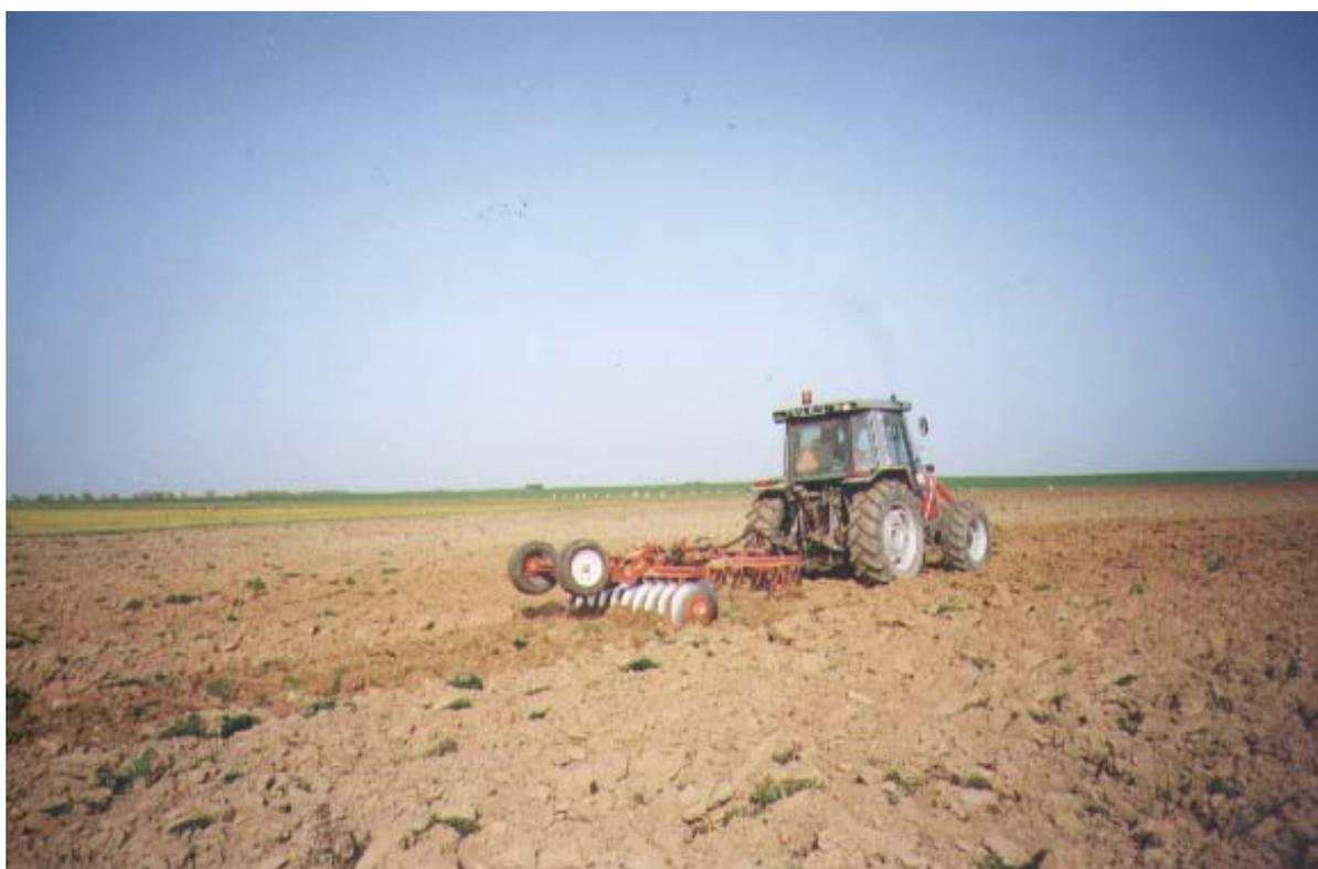
Figura 21- Ensaio realizado na Herdade do Louseiro, em solo lavrado, para avaliação do efeito da abertura dos corpos da grade e da velocidade de trabalho.
