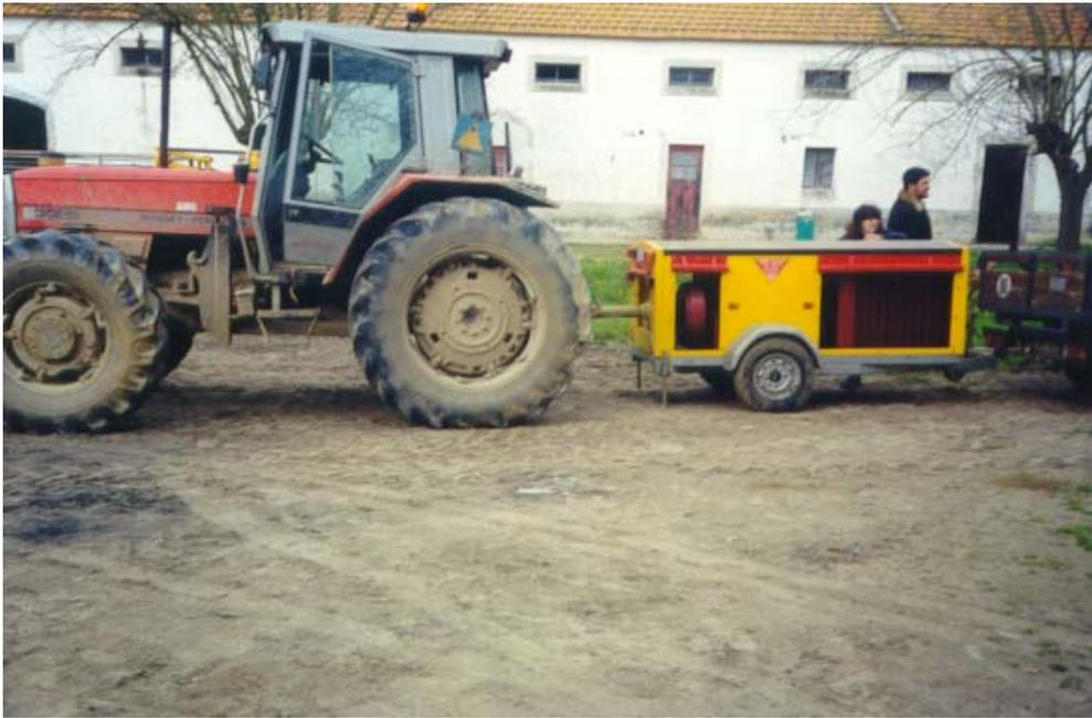
Figura 6-Ensaio do tractor Massey-Ferguson 3095 do Monte do Tojal com o freio dinamométrico.
