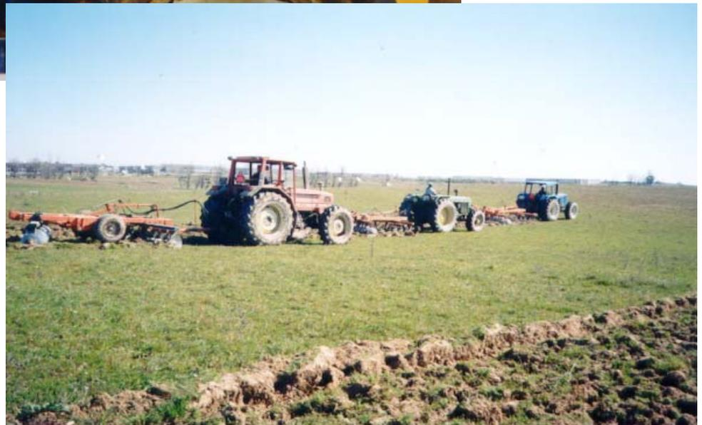
Figuras 22 e 23- Instalação do sistema de aquisição de dados noutros tractores e medição de esforços de tracção em grades dos agricultores.
