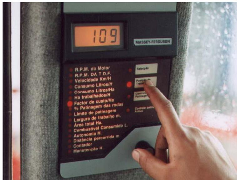
Figura 2 –Consola do sistema de informação “Datatronic” da Massey-Ferguson.
