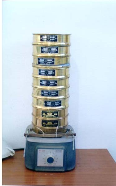
Figura 19- Bateria de crivos utilizada nos ensaios para determinação da dimensão dos agregados.
