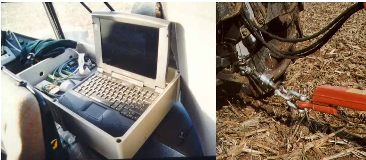
Figuras 8 e 9– Respectivamente, o Sistema de Aquisição de Dados instalado na cabina do tractor, à esquerda, e a célula de carga, à direita.
