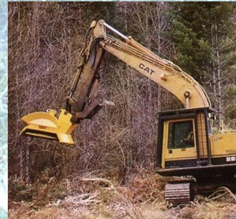
**Destroçador accionado por uma retroescavadora**
