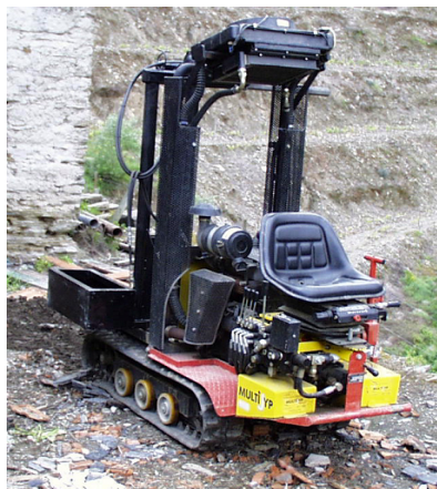
Figura 6- Unidade de tracção de pequena dimensão utilizada nos ensaios
