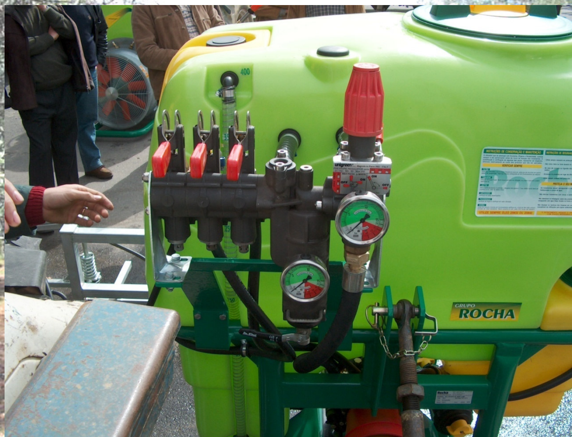
Distribuidor de calda
