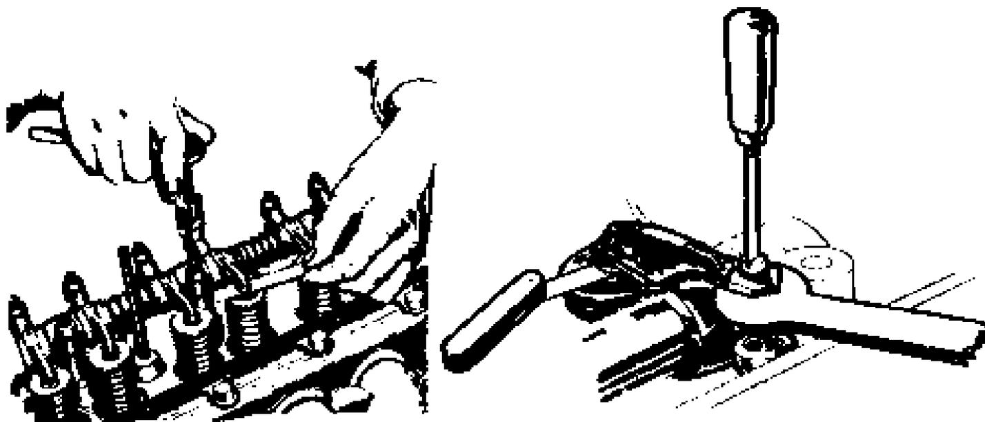
**Afinação das válvulas de um motor com válvulas à cabeça**
