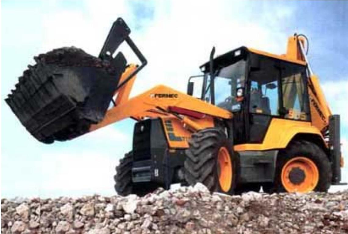
**Equipamento móveis de carregamento - retroescavadora com pá frontal e balde na parte traseira**
