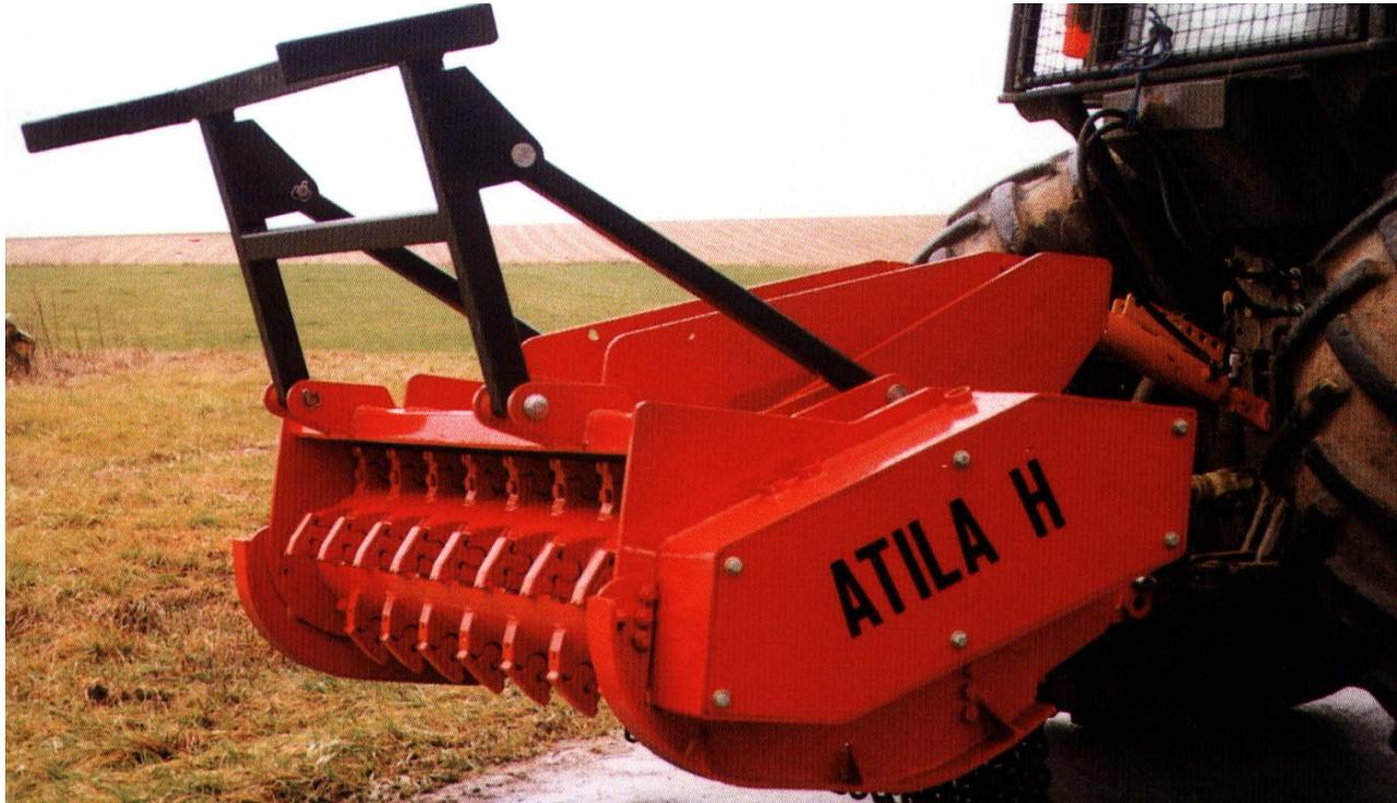
**Destroçador (vegetação e pedra) de eixo horizontal**
