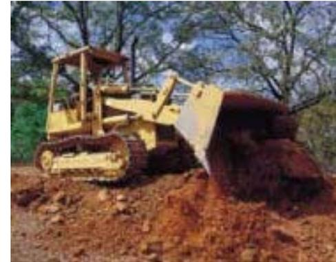
**Equipamento móveis de carregamento - tractor de rastos com pá carregadora de braços articulados**
