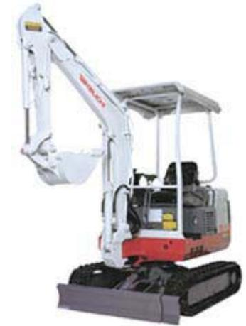
**Escavadora hidráulica a funcionar como retroescavadora
