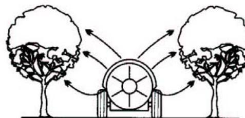
Representação esquemática da distribuição de ar num pulverizador de pressão de jacto transportado
