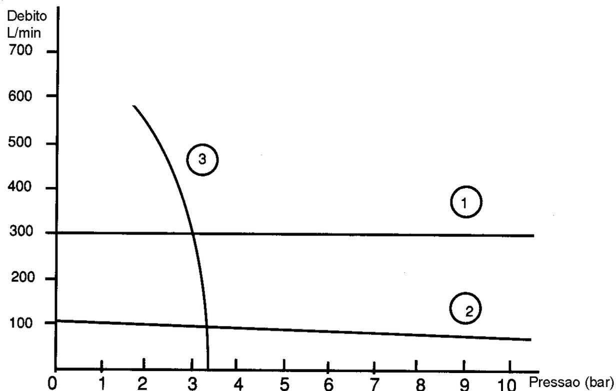
1- Bomba de 2 êmbolos; débito max.- 300 L/min; Velocidade- 400 rpm
