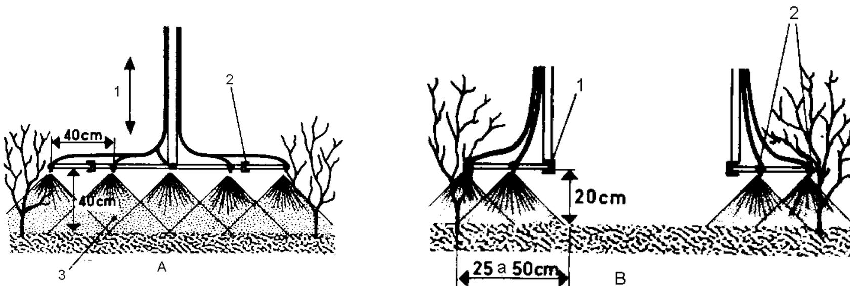
Representação de uma rampa para aplicação de herbicida na entre linha e rampas para aplicação na linha
