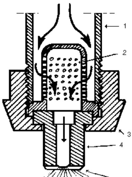
Corte esquemático de um bico de fenda
