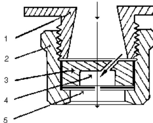
Corte esquemático de um bico de câmara de turbulência.
