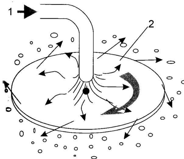
Esquema de um bico centrífugo.
