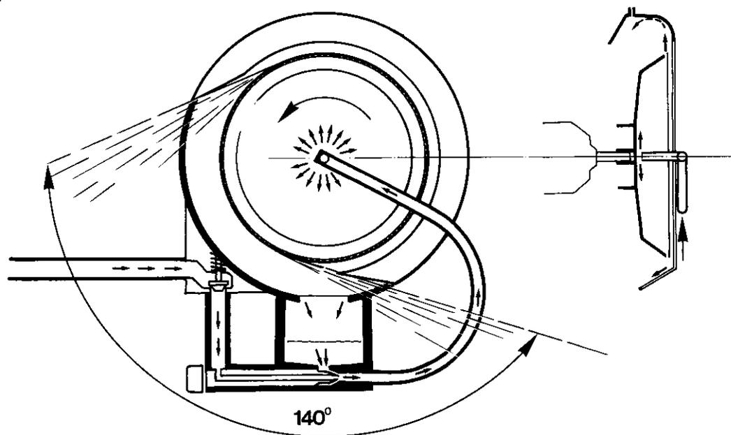
Representação de um bico de disco para a pulverização centrífuga
