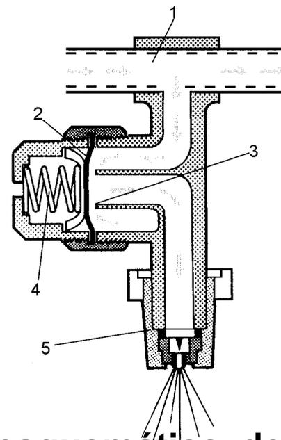
Corte esquemático de um bico de fenda com dispositivo anti-gota
