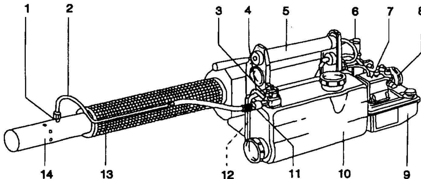
Representação de um pequeno pulverizador termopneumático
