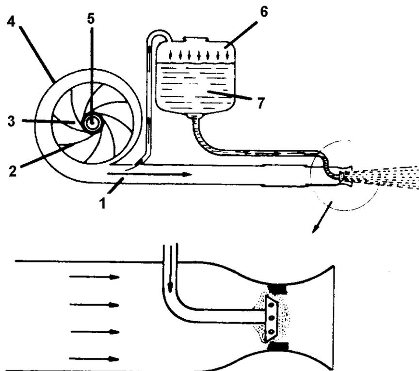
**Pulverizador centrífugo manual**
