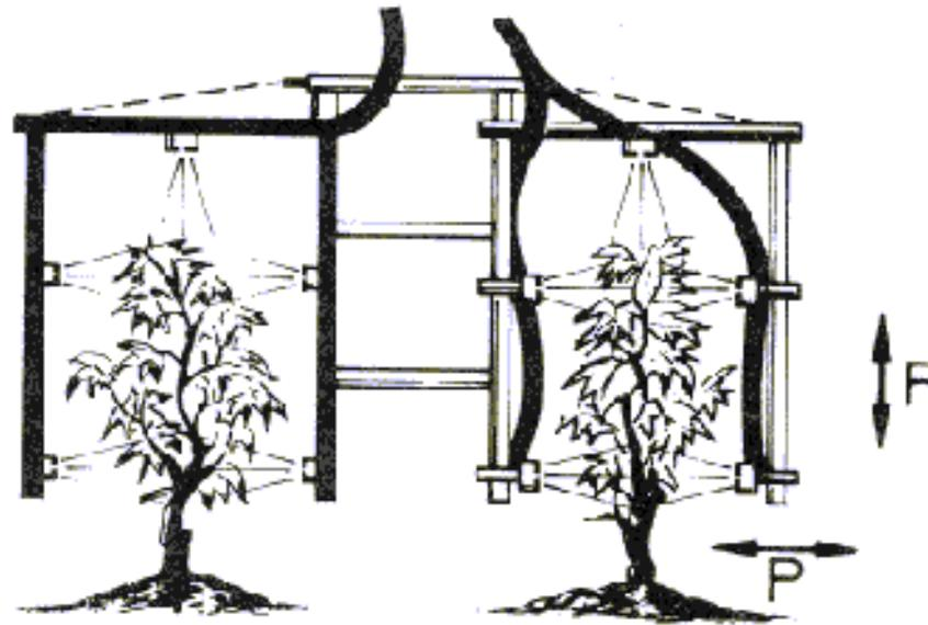
Esquema de uma rampa vitícola de um pulverizador de pressão de jacto
