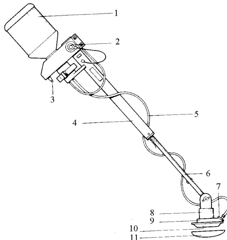
1- Depósito da calda, 2- Interruptor, 3- Pico , 4- Local onde se encontra as baterias, 5- Tubo da calda, 6- Tubo de extensão, 7- Bico, 8- Motor, 9- Disco, 10- Atomizador, 11- Prato
