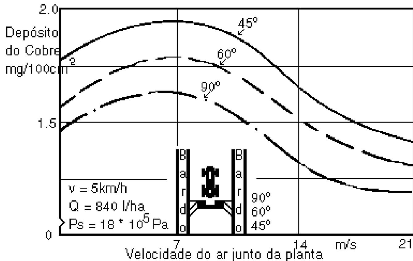
**Influência da velocidade do fluxo de ar direccionados e do ângulo de incidência na deposição de cobre na cultura da vinha**
