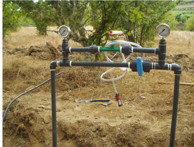
**Figura 10.4 - Equipamento para fertirrega**
