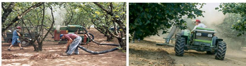
**Figura 12.4 - Colhedores pneumáticos rebocados: com apanha manual (a) e com apanha mecânica (b)**
