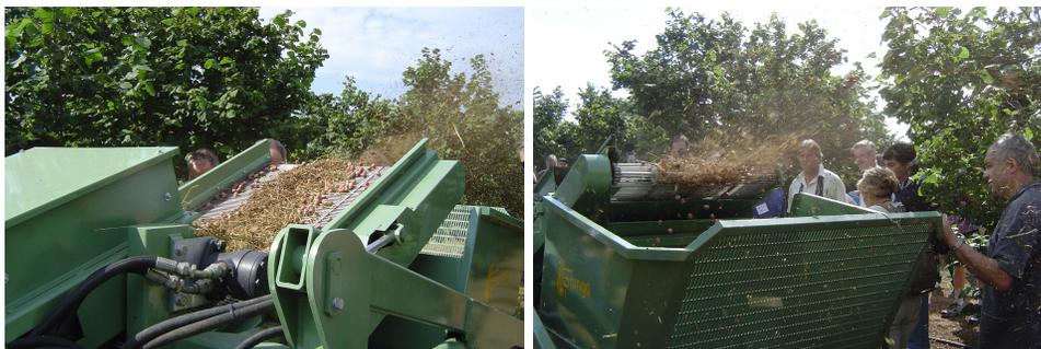
**Figura 12.5 - Colhedor de avelã com limpeza integrada**
