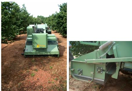
**Figura 12.1 - Colhedor mecânico automotriz com a avelã previamente encordoada e pormenor do pickup**
