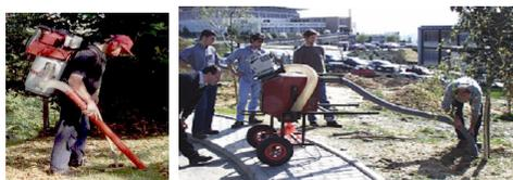
**Figura 12.3 - Colhedor pneumático de dorso (a) e colhedor manual com tracção manual (b)**
