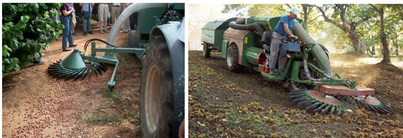
**Figura 12.7 - Colhedor misto rebocado (a) e colhedor misto auto-motriz (b), com encordoamento mecânico e recolha pneumática**
