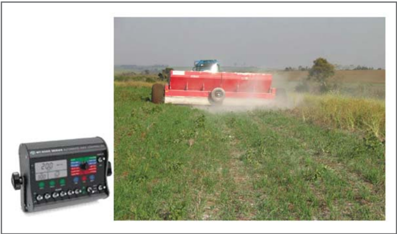
Figura 10.12: Aplicación de dosis variable de calcáreo dolomítico
