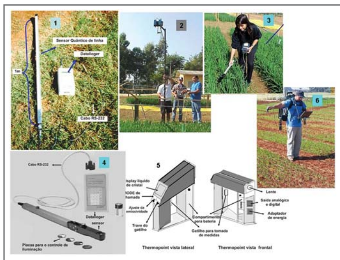
Figura 5.7: Sensores utilizados a nível de campo para medir la radiación reflejada o emitida de doseles agrícolas: sensor cuántico (1), Spectron SE-590 (2), LAI-2000 (3 y 4), Thermopoint (5) y 0 FieldSpec PRO FR (6).
