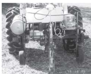
Figura 6.13: Sistema automático de muestreo de conductividad eléctrica del suelo
