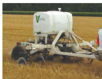
Figura 6.14: Barra porta sensores móviles Veris con pH Manager
