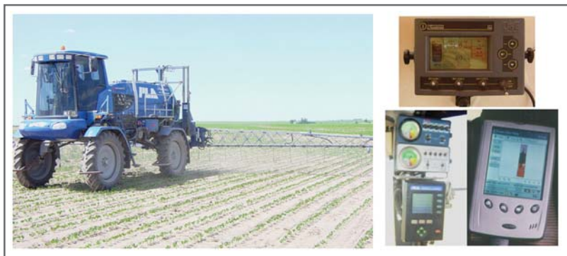
Figura 6.19: Pulverizadora autopropulsada con dosis variable de herbicida y fertilizante.
