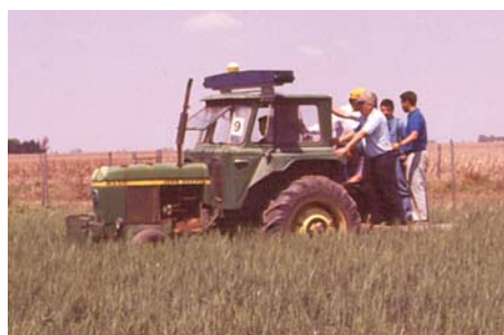
Figura 2.17: N-Sensor montado sobre tractor
