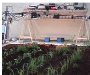
Figura 6.22: Sistema automático de identificación y control de malezas desarrollado por la Universidad Católica de Lovaina, Bélgica (De Baerdemaeker, 2004).
