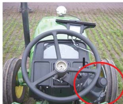
Figura 2.23: Piloto automático montado sobre un tractor.
