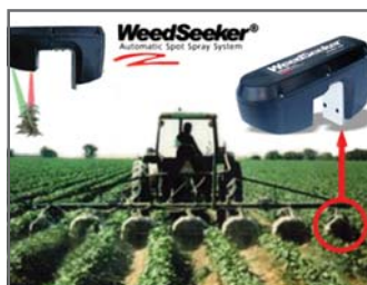
Figura 6.20: Sistema automático de identificación y control de malezas WeedSeeker desarrollado por la Universidad Estatal de Oklahoma (OSU).
