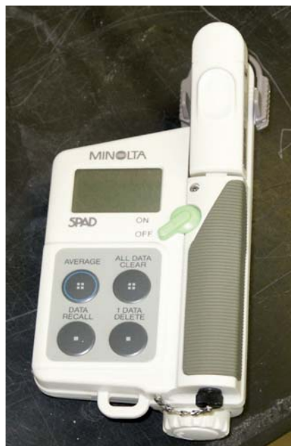
Figura 2.16: Monitor de Clorofila.
