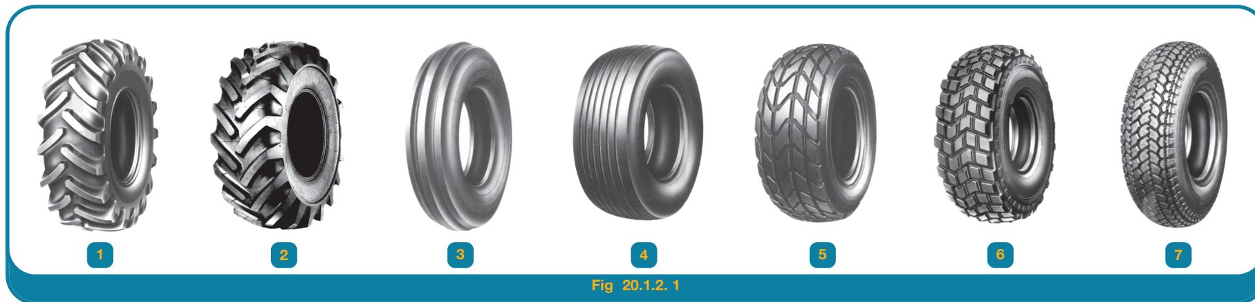
A superfície de rolamento do pneu é constituída por uma mistura de borracha resistente ao desgaste. A aderência ao solo depende do tipo de rasto, bem como do tipo da própria borracha; resumindo: da constituição da borracha e do pneu.
