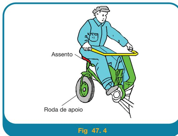
lateral e o movimento provém de uma biela. Pode existir uma terceira roda, de apoio, que se situa por baixo do assento do operador (Fig 47.4).
