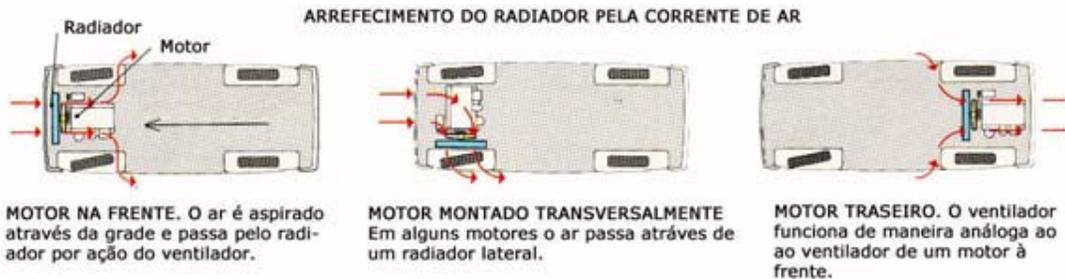
Quando o veículo tem o motor na frente, o ar frio é aspirado através da grade e passa pelo radiador pela ação do ventilador, No motor montado transversalmente, em alguns casos o ar passa através de um radiador lateral. Já no motor montado na parte traseira do veículo, o ventilador funciona de maneira análoga ao ventilador de um motor à frente.
