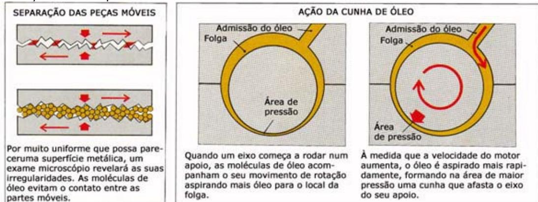
Nenhum eixo se ajusta perfeitamente ao seu apoio pois, caso contrário, não conseguiria rodar. Existe uma folga diminuta entre as superfícies (cerca de 0,07 mm nos apoios das cabeças das bielas, com 50 mm de diâmetro), formando-se no apoio uma película de óleo na área onde a folga é maior. A rotação do eixo aspira o óleo para o ponto de carga máxima, onde a folga é mínima, forçando o óleo a tomar a forma de uma "cunha" entre o eixo e o apoio.
