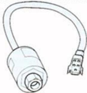
Tem como objetivo proteger o ar condicionado contra pressões excessivamente altas e baixas e também controlar a ventoinha. Fica localizado no topo do tanque secador (apenas nos sistemas de ar condicionado com válvula de expansão de seção variável).
