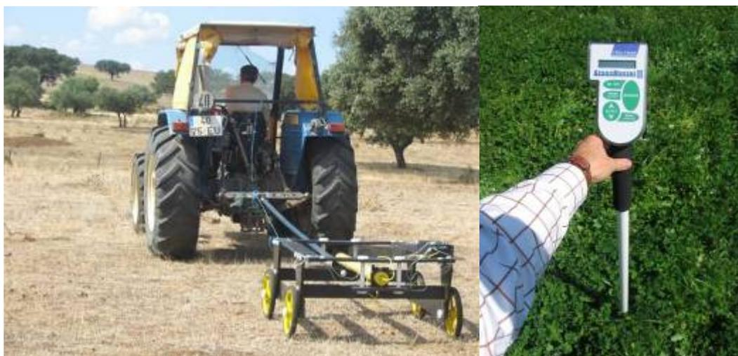
**Figura 75** – Medidor de condutividade eléctrica do solo “DUALEM” (à esquerda) e medidor da massa de matéria seca da pastagem “Grassmaster II” (à direita)
