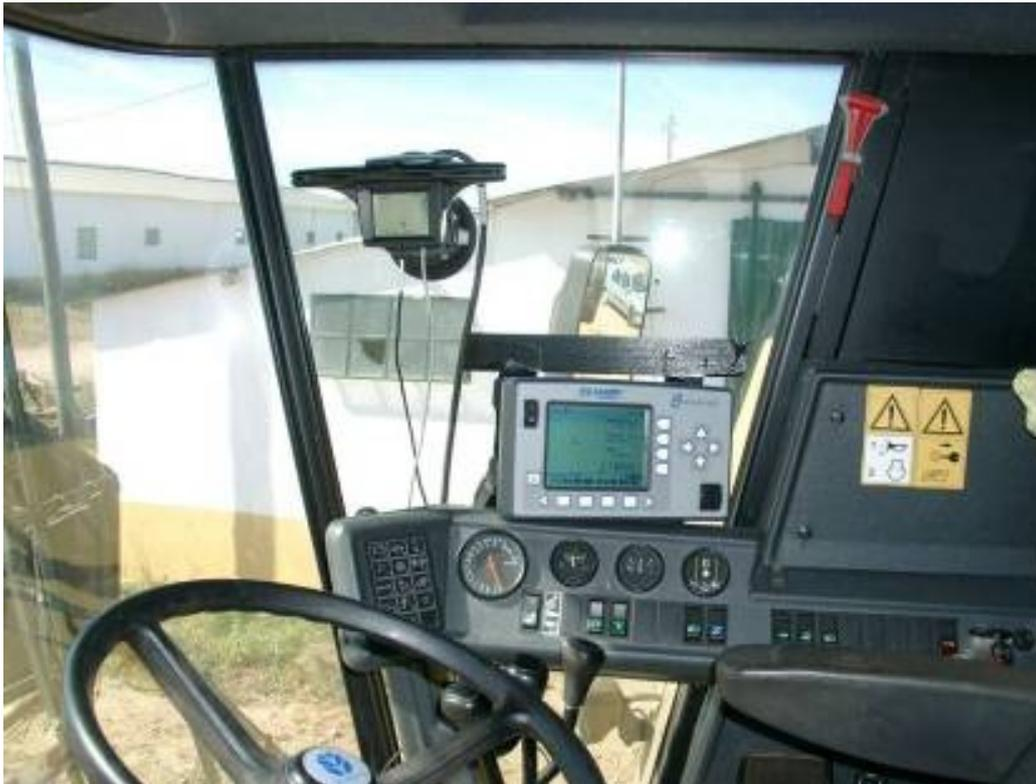
**Figura 33** - Aspecto do interior da cabine da ceifeira com a consola instalado no campo de visão e acção do operador
