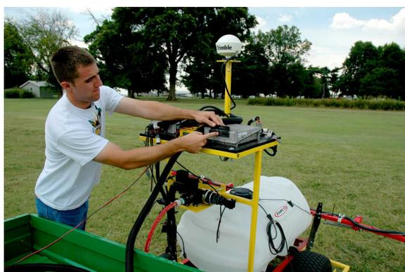
**Figura 9** – Sistema de navegação com GPS, GIS e controlador VRT
