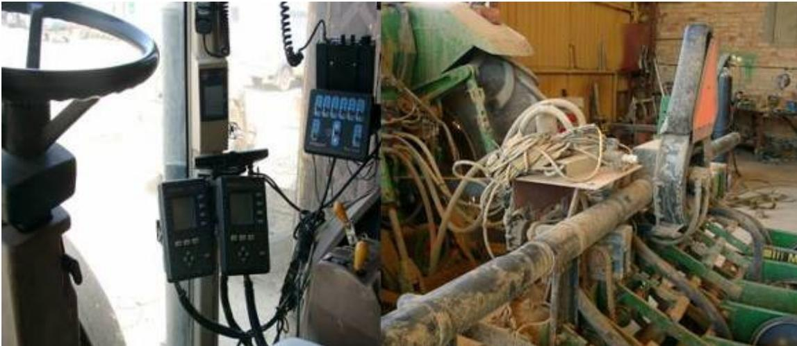
**Figura 30** – Sistema de VRT de semente Dickey-John instalado num semeador John Deere de 6 linhas. À esquerda o controlador VRT instalado na cabine do tractor. À direita o variador de fluxo visto de trás
