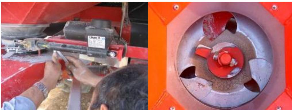
Figura 58 - À esquerda, actuador eléctrico; à direita, abertura das placas de dosagem do adubo
