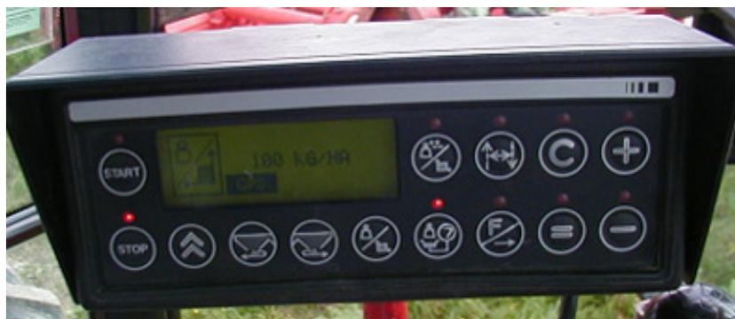
**Figura 56** – “Ferticontrol” sistema de comando do distribuidor centrífugo de adubo "Vicon RS -EDW"
