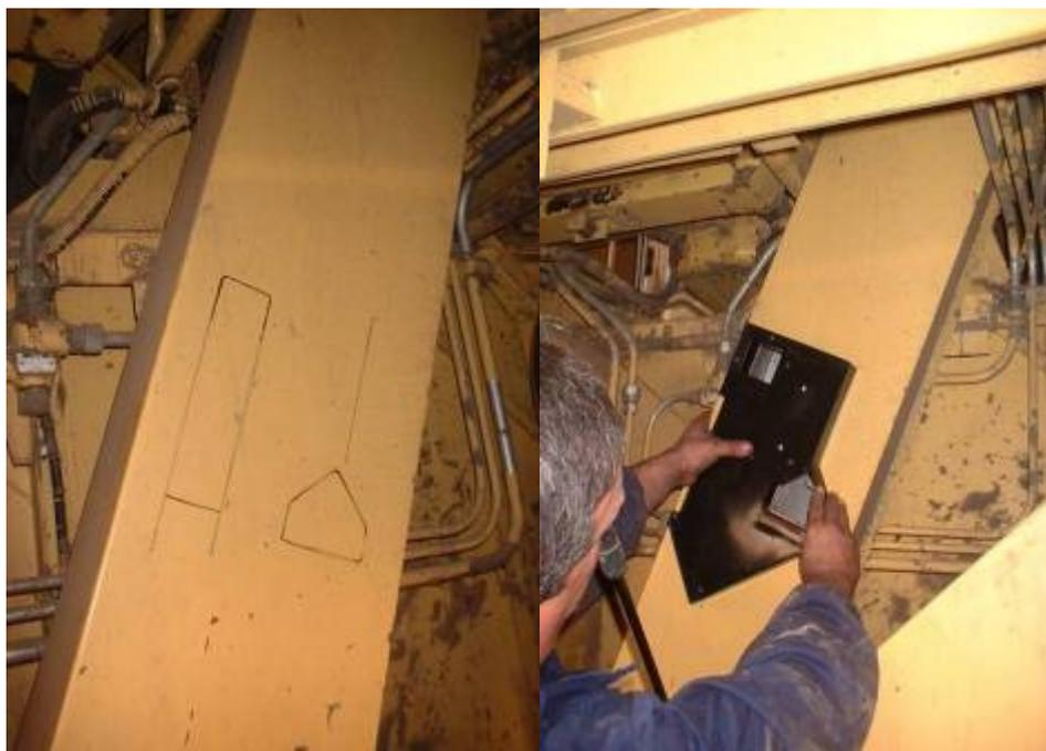
**Figura 36** - Marcações e ajuste do sensor de humidade no elevador de grão
