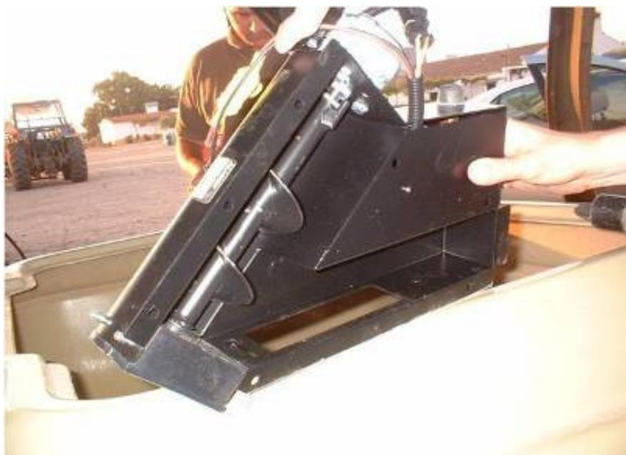
**Figura 37** - Sensor de humidade do grão
