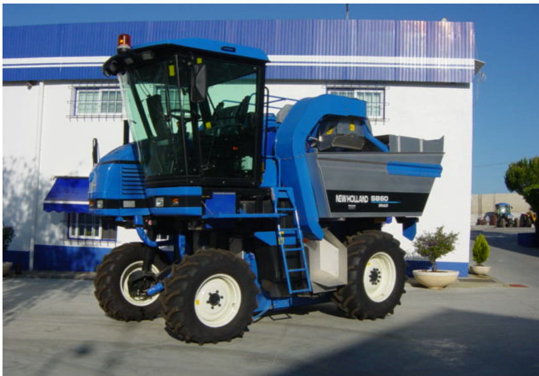
Figura 3 – Na Europa os modelos de vindimadora utilizados incorporam dois tegões no corpo da máquina
