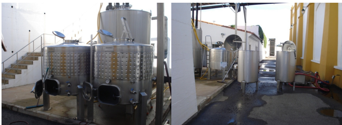
Figura 13 – Cubas de fermentação com temperatura controlada (esquerda) e "sempre cheias" (direita) utilizadas para vinificar os dois lotes em estudo
