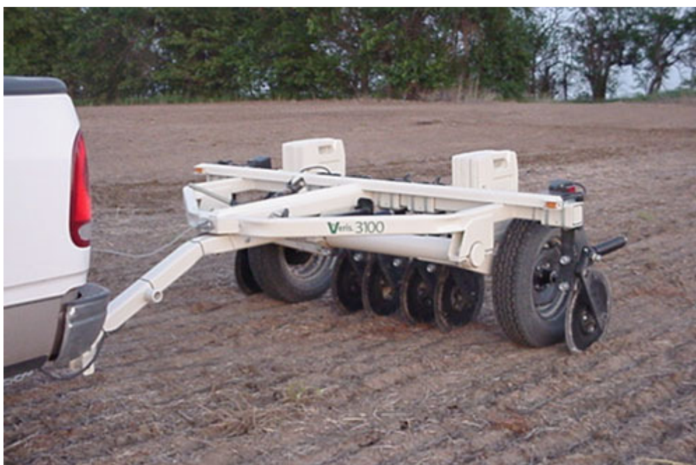
Figura 6 – Sensor de condutividade eléctrica aparente do solo por contactos Veris 3100 da Veris technologies
