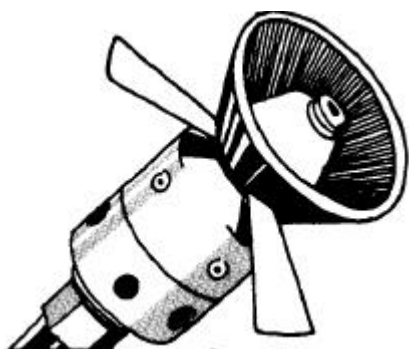
Figura 2.28- Representação de um bico rotativo cónico, com hélices, accionado pela corrente de ar do ventilador. Fonte: Catálogo Agrotécnica
