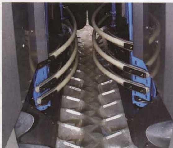
Système de réception et de transfert avec noria de godets New-Holland, secoueurs fermés
