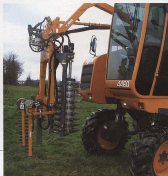
Machine à vendanger en mode prétailluse
