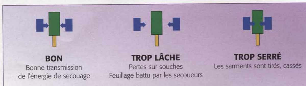
Schéma 1 Illustration du réglage du pincement
