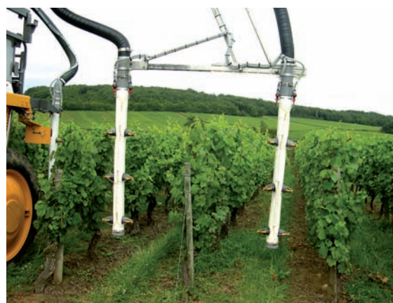
Descentes interlignes souples pour vignes étroites (Grégoire).
