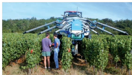
Evaluation technique d'une voûte élargie en vigne étroite.
