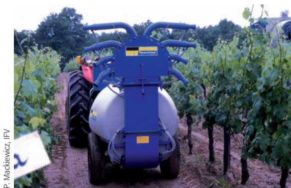
Voûte pneumatique multi-sorties en vigne large.
