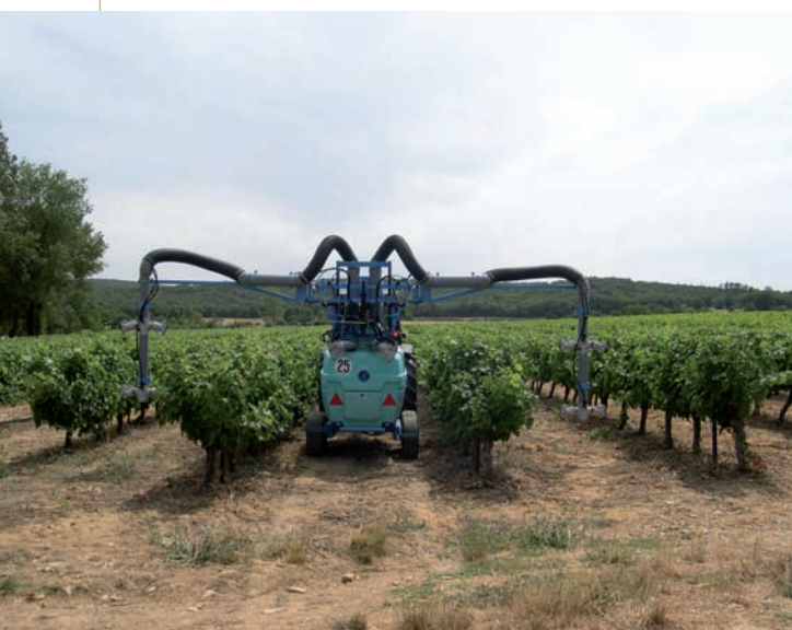
Rampe AB Most en vigne large.
