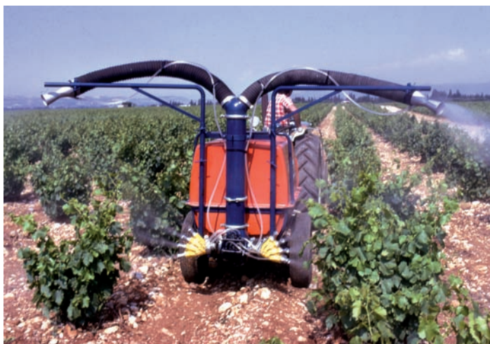
Pulvérisateur pneumatique en configuration "2 mains – 2 canons" pour le traitement direct de 4 faces par passage.
