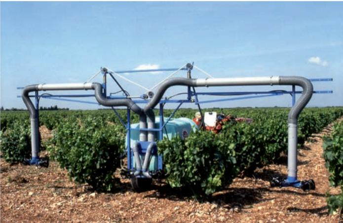
*Sur un appareil pneumatique, adjonction d'une adaptation « anti-botrytis » permettant le traitement simultané de trois rangs (2 rangs + 2 demi-rangs) en simultané.*
