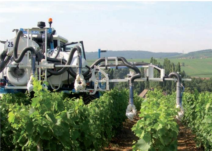
*Sur Jet 6000, au centre de l'appareil : position des mains en traitement de couverture, à droite position des mains en traitement des grappes.*
