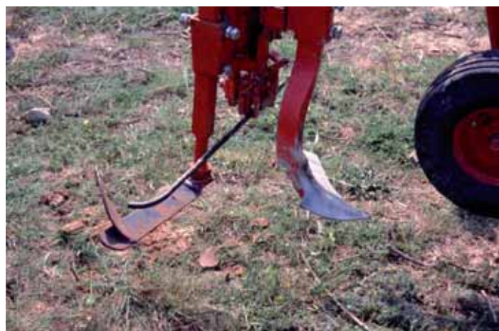
Cutmatic Boisselet avec coudre à l'avant pour faciliter le travail de la lame
