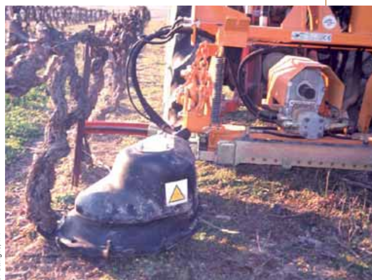
Tournesol Pellenc avec palpeur de recentrage et cloche de contournement par appui
