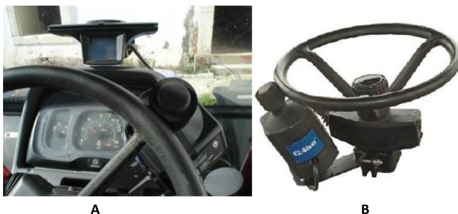
Figura 5- Sistema de condução automática com atuação no volante por um motor elétrico. Fonte: Sullivan e Ehsani (2002)
