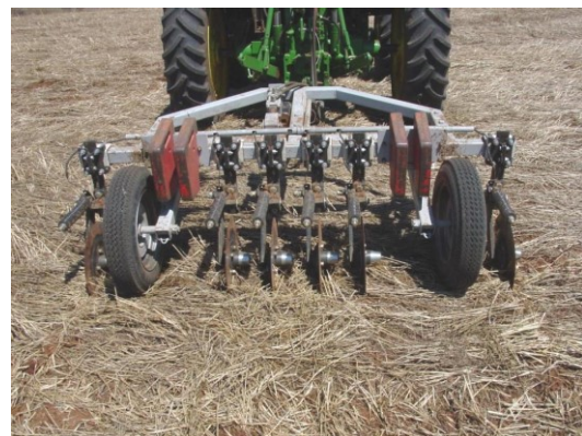
Figura 43- Sensor de contato para determinação da condutividade elétrica do solo a duas profundidades
