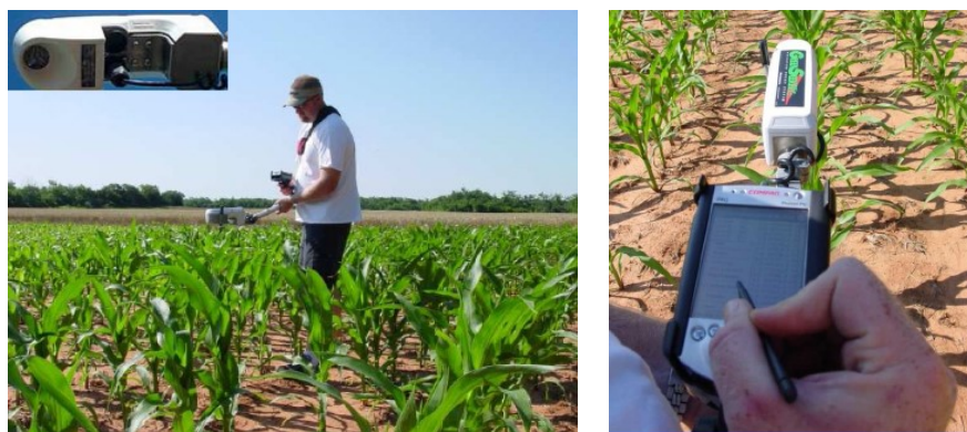
Figura 23- Medição da energia radiante refletida / emitida (refletância) pelas folhas.
