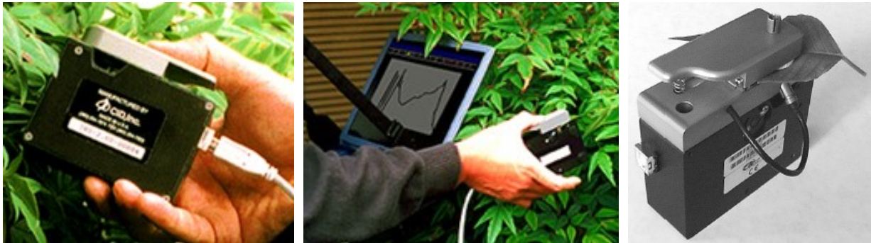
Figura 22- Medição da energia radiante transmitida (transmitância) através das folhas
