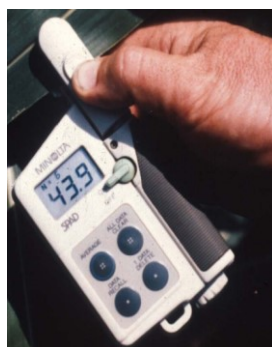
Figura 24A e B- Medidor de clorofila SPAD (“clorofilómetro”) e gráfico da evolução dos seus valores na cultura do milho
