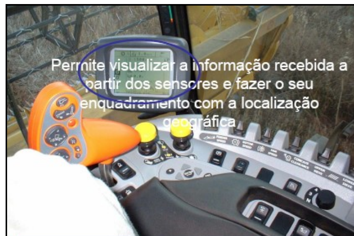
Figura 12- Computador de bordo. Fonte: Varella, C. (2007).
