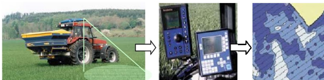
Figura 7- Aplicação de azoto com base em mapas; a informação é adquirida antes da aplicação do azoto para permitir o mapeamento da variabilidade espacial do verde (azoto) e biomassa.
