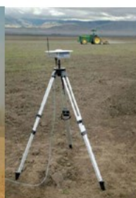
Figura 10- Correção diferencial utilizando uma torre local via rádio UHF
