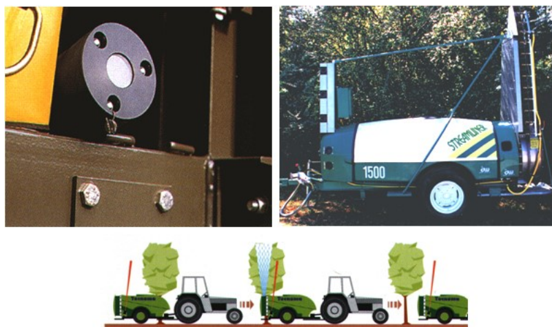
Figura 12- Aplicação diferenciada em arboricultura utilizando um sistema sonar
