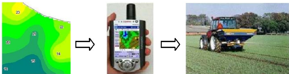
Figura 2- Utilização de um PDA para leitura de um mapa de aplicação e gestão do controlador de um distribuidor de adubo
