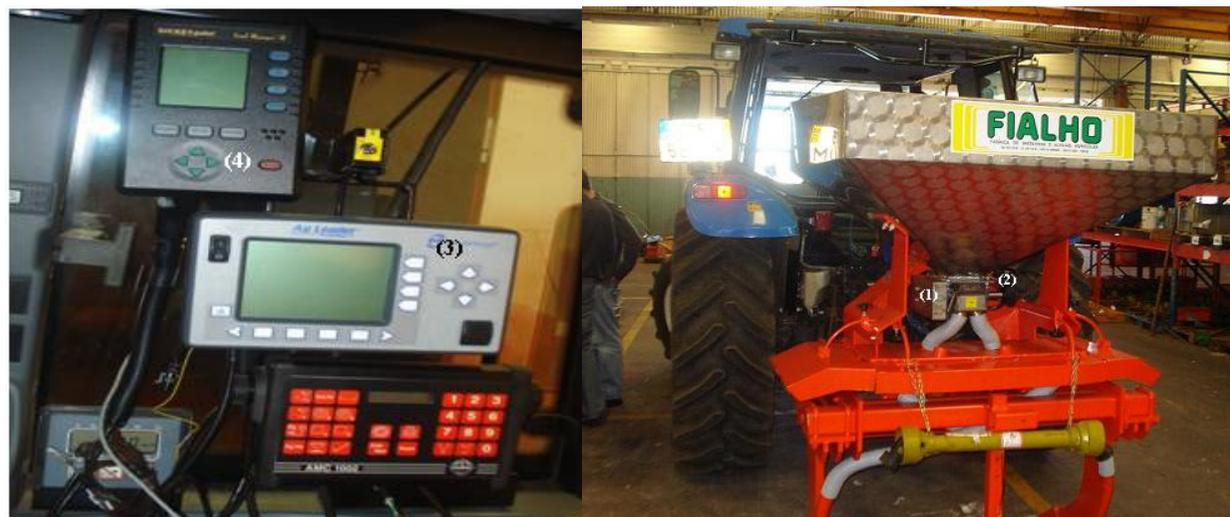
Adaptação de um distribuidor de adubo convencional com possibilidade de funcionar em modo centrífugo ou enterrando o fertilizante em dois dentes.
