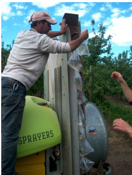
Figura 7 (1 e 2)- Recolha de água de cada um dos bicos e determinação do seu volume.
