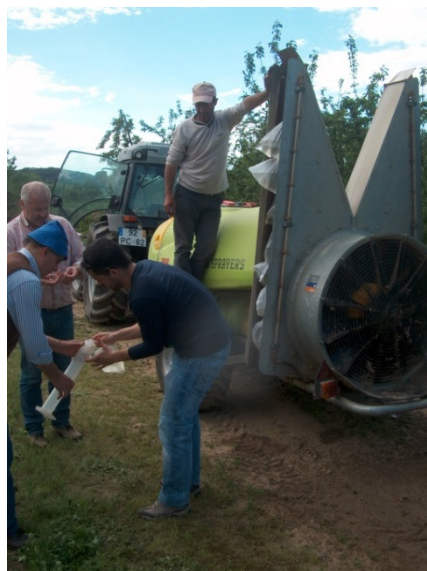
Figura 7 (1 e 2)- Recolha de água de cada um dos bicos e determinação do seu volume.
