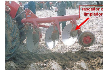
Arado tridisco suspendido con rueda de apoyo
