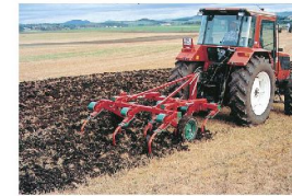
Accionamiento por tracción: arado chisel
