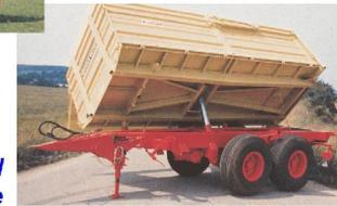
Remolque de dos ejes, en los que la carga se reparte uniformemente sobre ambos ejes y la lanza solo recibe esfuerzos de tracción y compresión al estar articulada tanto en el remolque como en el tractor.
