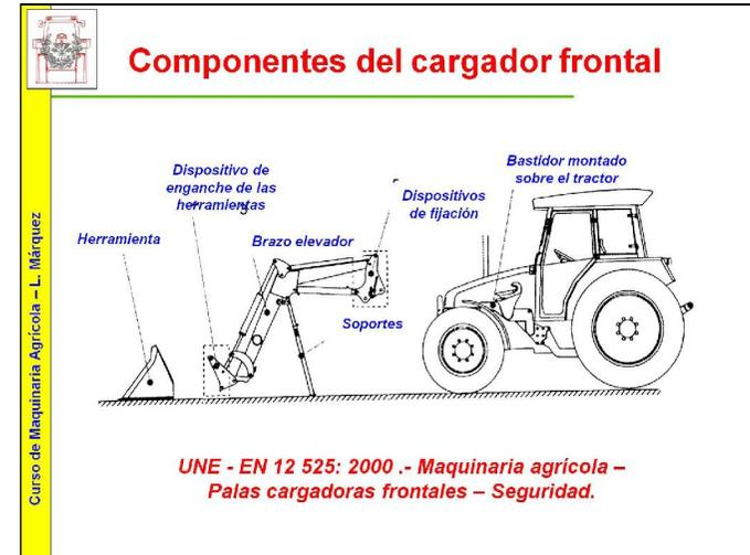
Debe incluir un dispositivo de apoyo que permita mantener los brazos elevadores en una posición estable cuando se desmonta del tractor.
