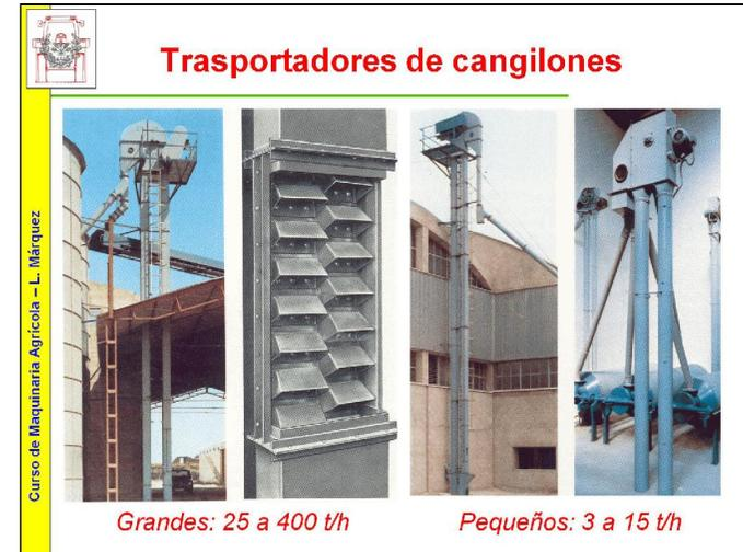
Por los elementos que utilizan para desplazar el material se pueden establecer dos categorías principales: mecánicos y neumáticos. Entre los mecánicos, por el tipo de elementos que realizan el transporte, se clasifican como: de cangilones, de cadenas, de tornillo sinfin, y de bandas continuas.
