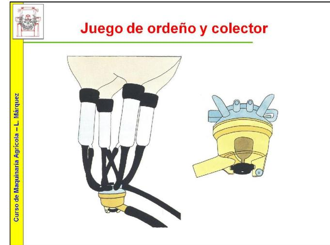
Es la base del sistema de ordeño e incluye las pezoneras, formadas por un manguito flexible en el que se introduce el pezón y un copa rígida que mantiene tenso el manguito; los manguitos de ordeño van unidos a un colector que dispone de un orificio calibrado que da entrada directa al aire atmosférico.
