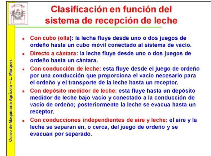
En función de la **posición del sistema de leche** (de las boquillas de entrada de la leche, del cubo o cántara, conducción de leche, o depósito medidor) con respecto al nivel del suelo que ocupa el animal se establecen:
