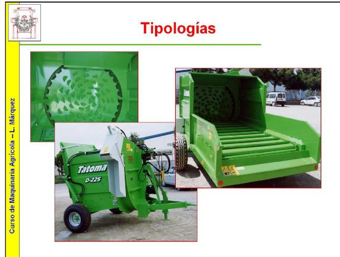
Se pueden establecer diferencias en función de la capacidad de la caja y su adecuación al picado de diferentes materiales. Normalmente son máquinas semi-suspendidas con un solo eje, aunque aquellas que disponen de tolvas de pequeño tamaño también se diseñan como suspendidas para el tripulante del tractor.
