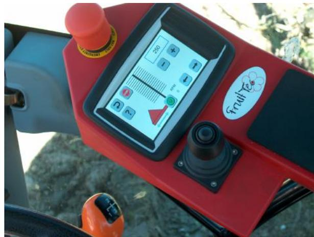
**Figura 3-** Consola com a opção da mondadora mecânica selecionada. O joystick é utilizado para afasta e inclinar o sistema de monda.
