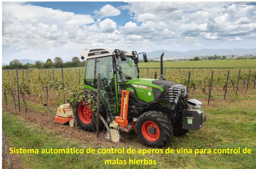
**Sistema automático de control de aperos de viña para control de malas hierbas**
