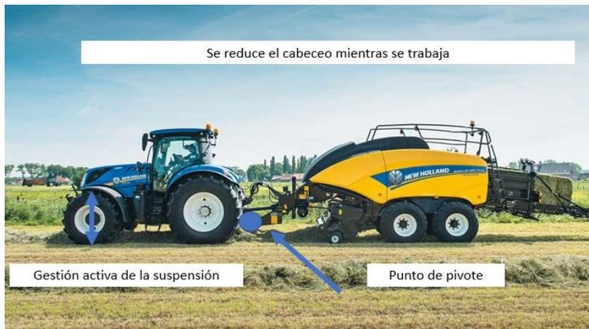
**Sistema de control de empacadora par el tractor T7**
