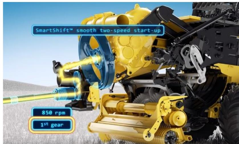
**Caja intermedia smartdhift para arranque de empacadora de alta densidade**
