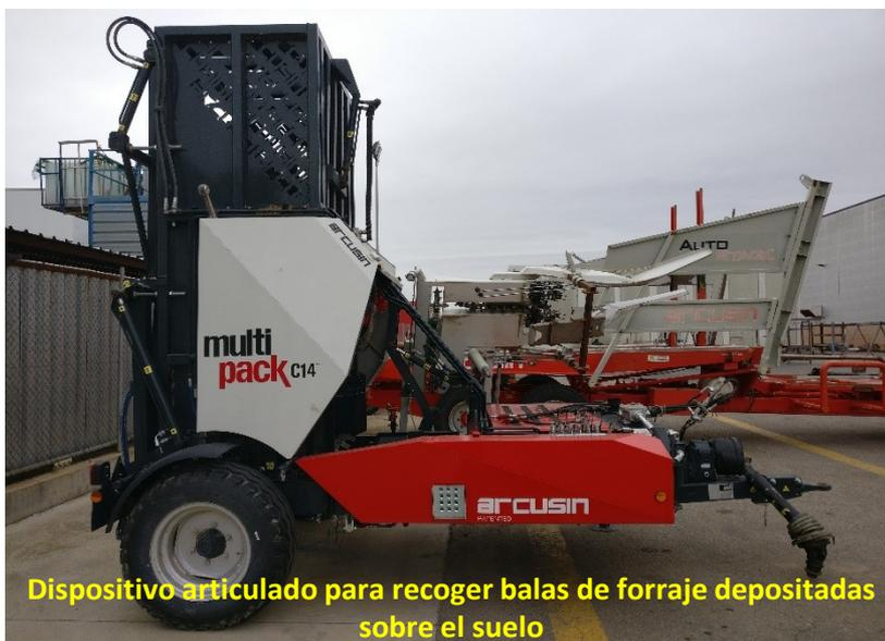
Dispositivo articulado para recoger balas de forraje depositadas sobre el suelo
