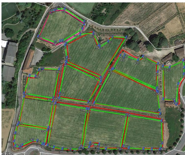
**Figura 5-** Comparação dos limites das folhas utilizando o GE e o MS
