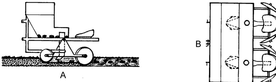
**Figura 2-** Representação de um plantador com alimentação manual e tubo de descida
