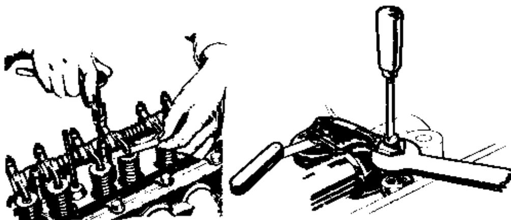
**Figura 6-** Afinação das válvulas de um motor com válvulas à cabeça
