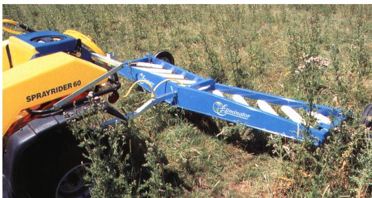
**Figura 17-** Pulverizador de contacto
