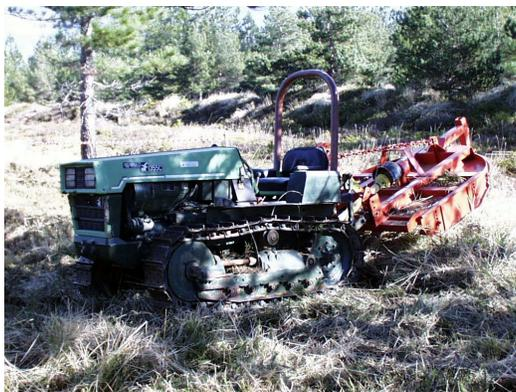
**Figura 22-** Fotografia do equipamento utilizado nos ensaios com o corta matos
