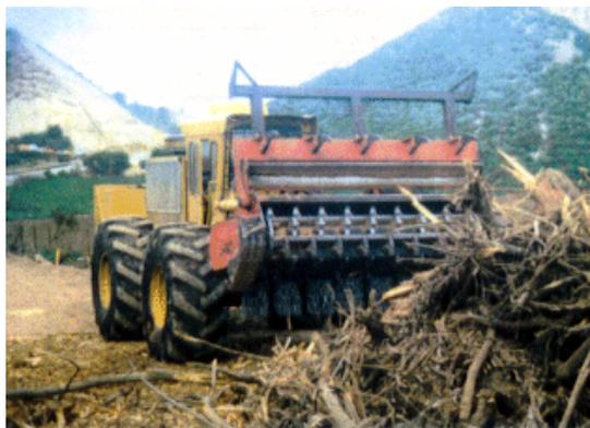
**Figura 10-** Fotografia de um corta matos de eixo horizontal e facas articuladas
