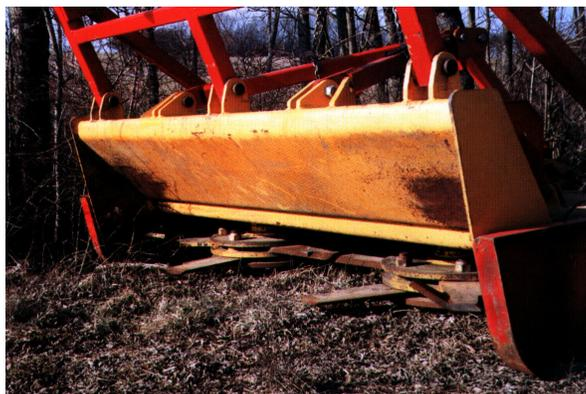
**Figura 9-** Corta matos de eixo vertical
