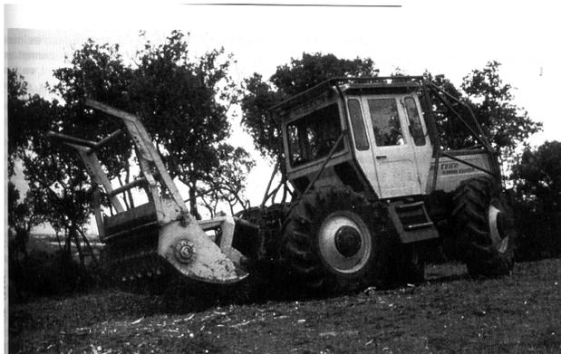
**Figura 15-** Fotografia de um equipamento mecânico pesado (MB TRAC 1300) com um triturador de eixo horizontal de 189 cm
