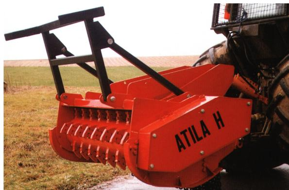
**Figura 13-** Corta matos de eixo horizontal com martelos fixos
