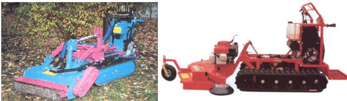
**Figura 2.5-** Fotografias de trituradores de sarmentos (eixo horizontal e eixo vertical)
