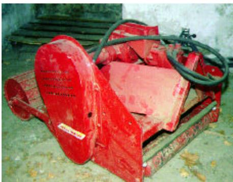
**Figura 4.4-** Triturador de sarmentos utilizado nos ensaios
