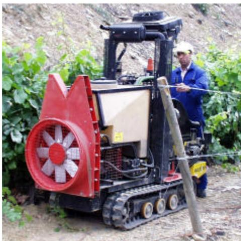
**Figura 4.6-** Pulverizador de jacto transportado utilizado nos ensaios
