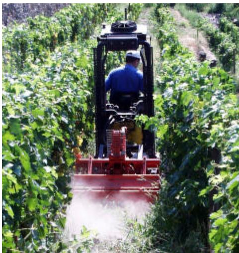
**Figura 5.4-** Enxada mecânica a trabalhar numa vinha tradicional reconvertida
