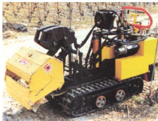
**Figura 2.6-** Fotografias de equipamentos de mobilização (escarificador e enxada mecânica)
