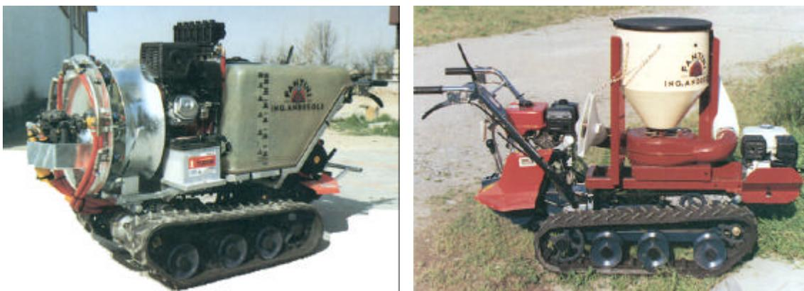
**Figura 2.7-** Fotografias de um pulverizador de jacto transportado e de um polvilhador.
