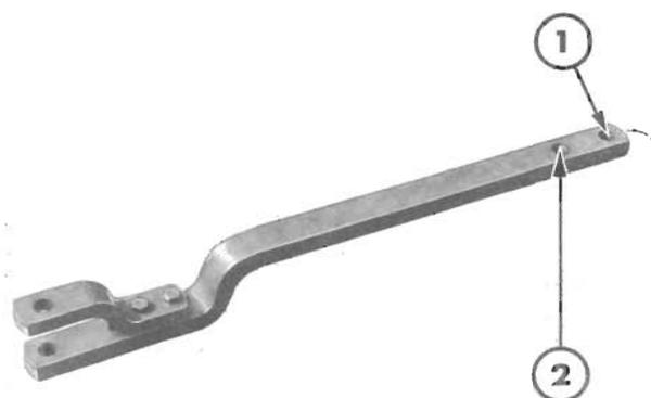
87 — — — A cavilha da forquilha pode ser introduzida em qualquer dos dois furos para variar a distância entre o veio da tomada de força e o ponto de engate:
