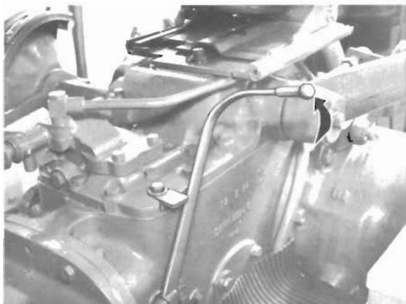
49 Mover a alavanca selectora para a frente para engatar a tomada de força — — —
