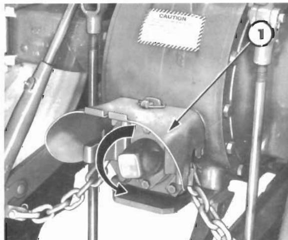
43 Desapertar o tampão da tomada de força no sentido contrário ao do movimento dos ponteiros dos relógios. Montar a blindagem protectora (1).
