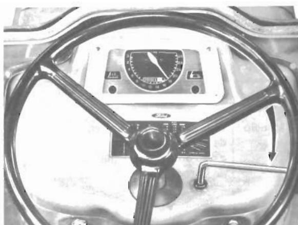
50 — — — Aumentar a velocidade do motor para 1800 r.p.m. a fim de se obter 540 r.p.m. no veio da tomada de força.
