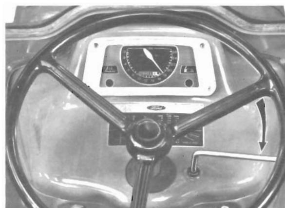
**45** — — — Aumentar a velocidade do motor para 1600 r.p.m. (nos Ford 2600, 3600 com caixa de 8 velocidades) ou 1800 r.p.m. (em todos os outros modelos).
