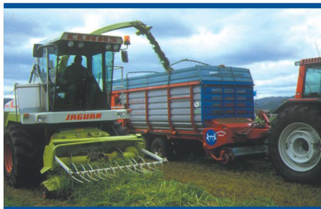
Figura 40: Cosechadora picadora de forraje
