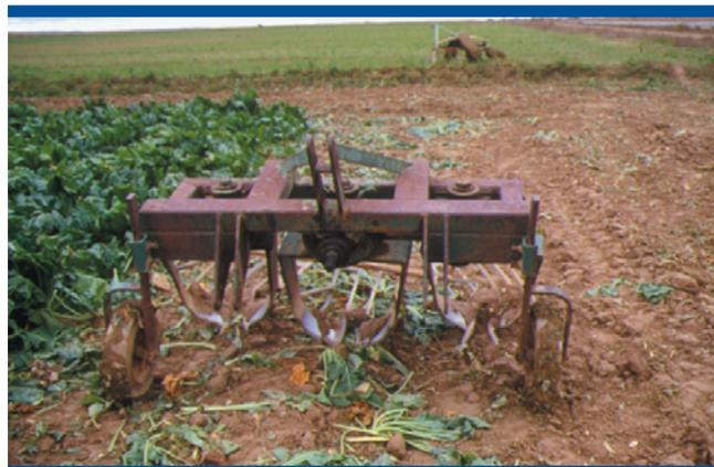
**Figura 30:** Arrancadora e hileradora de remolacha
