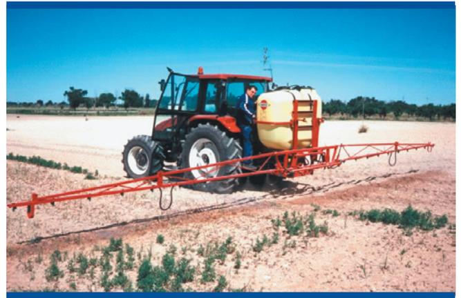
Figura 25: Pulverizador hidráulico
