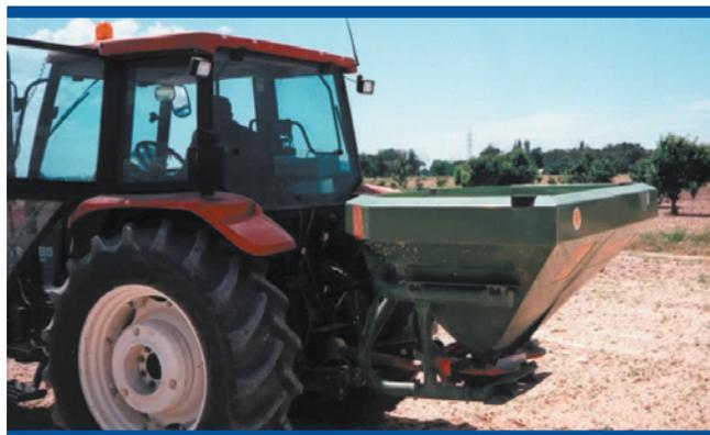
Figura 15: Abonadora centrífuga de disco
