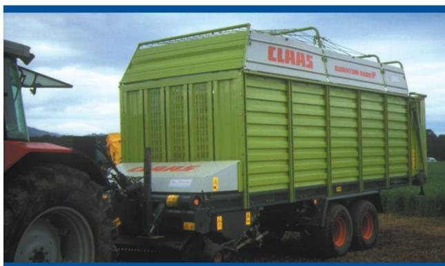
Figura 39: Remolque autocargador
