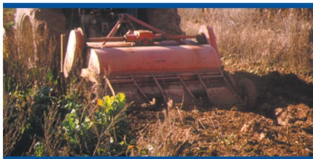
Figura 29: Deshojadora-descoronadora de remolacha
