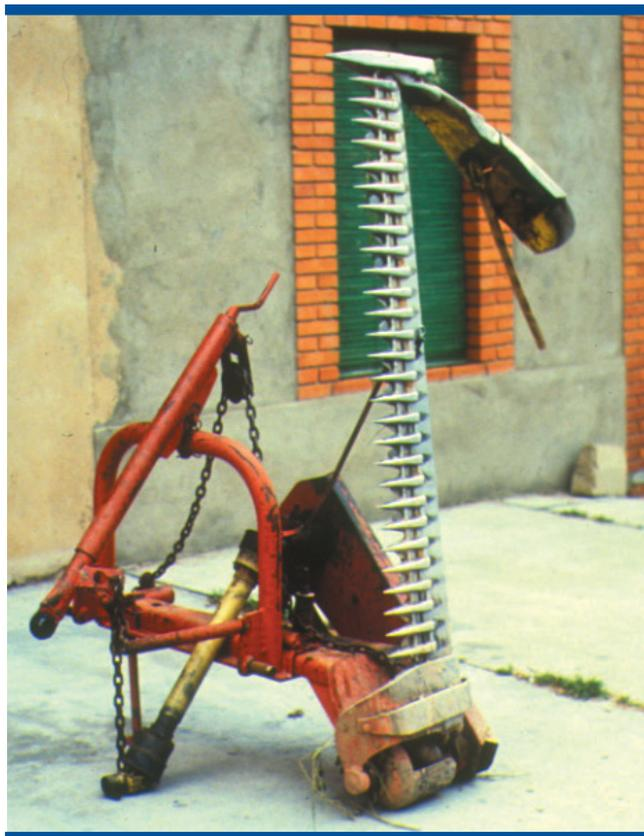
Figura 34: Segadora de forrajes con barra de corte
