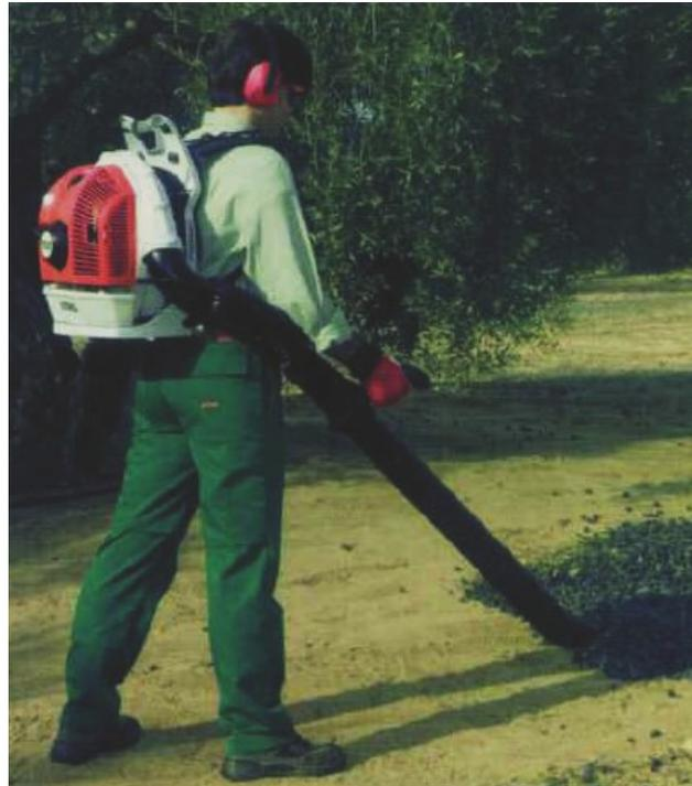
Os sopradores com ventiladores de grande débito e velocidade de ar permitem, como resultado da diferente densidade do material vegetal depositado no solo (frutos, folhas, etc.), **uma primeira separação desse material** o que facilita a apanha da azeitona.
