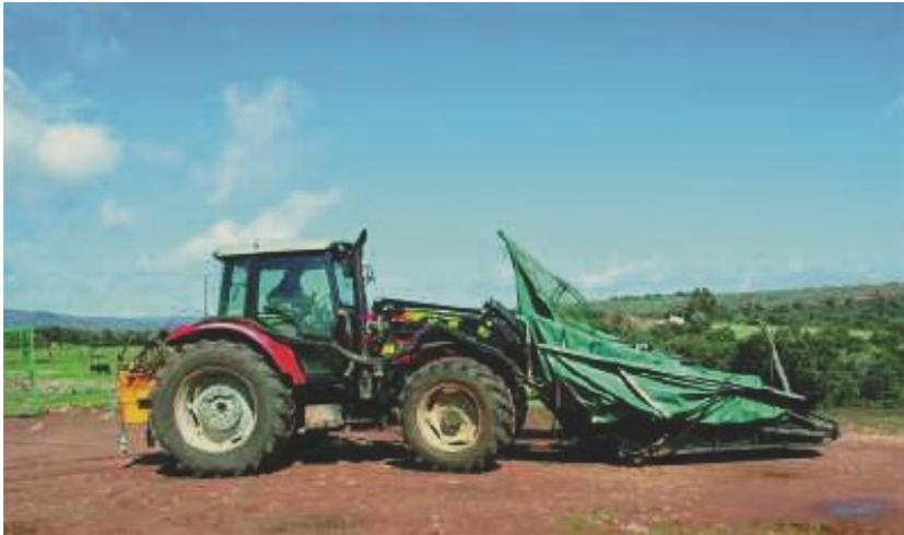
**Vista lateral de um vibrador
