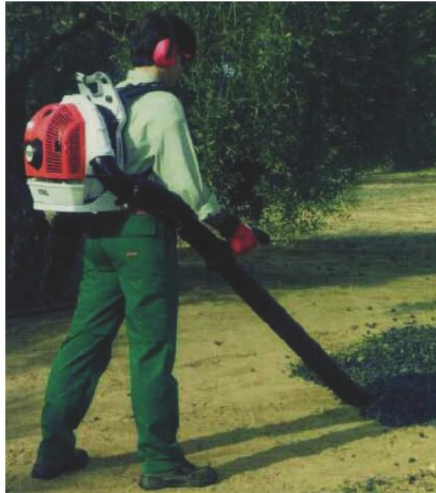
Os sopradores com ventiladores de grande débito e velocidade de ar permitem, como resultado da diferente densidade do material vegetal depositado no solo (frutos, folhas, etc.), **uma primeira separação desse material** o que facilita a apanha da azeitona.
