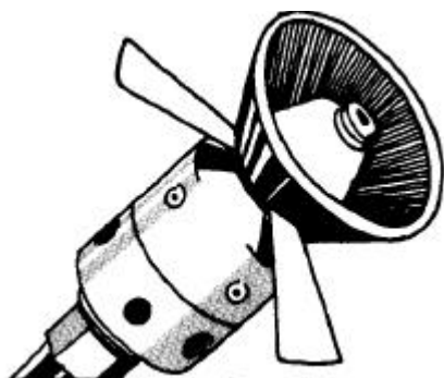
Figura 3.30- Representação de um bico rotativo cônico, com hélices, accionado pela corrente de ar do ventilador.
