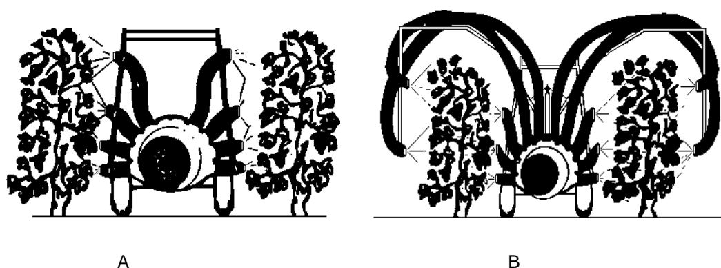
Figura 3.39- Adaptação de um pulverizador de jacto transportado à cultura da vinha instalada em patamares de dois bardos. A- versão original B- versão alterada Fonte: Santos, F. (1992)
