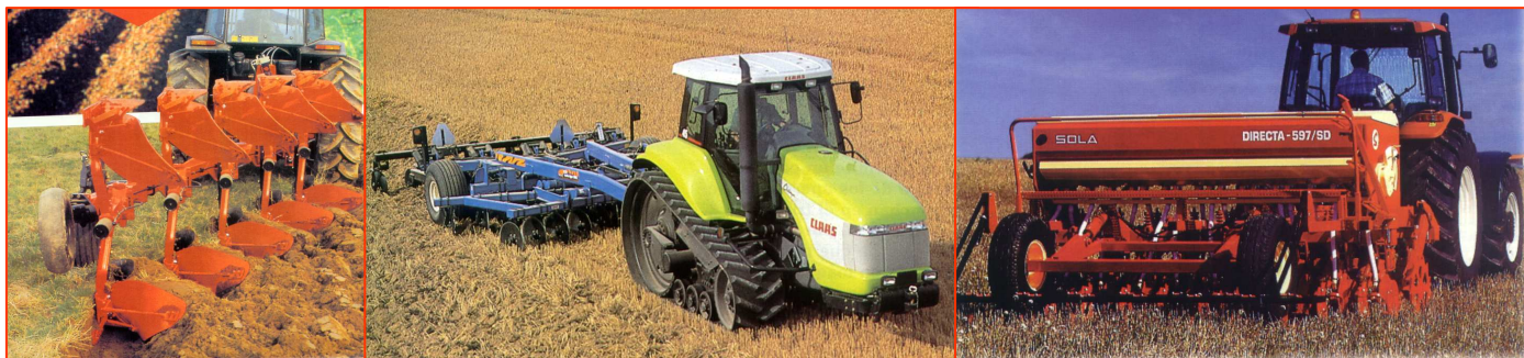
Figura 6-Diferentes itinerários de preparação do solo para a sementeira: desde a lavoura tradicional, passando pelas técnicas de mobilização reduzida até à sementeira directa.
