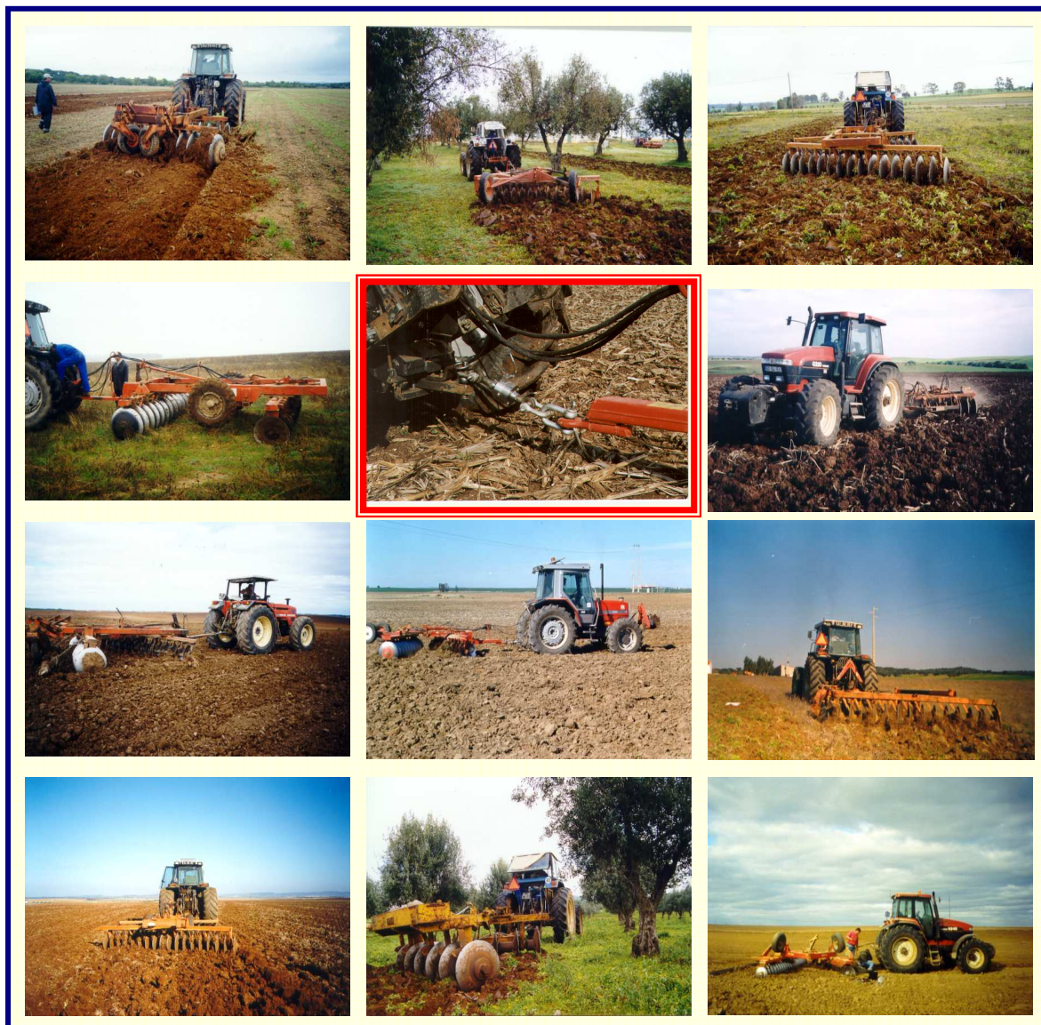
Figura 1- Ensaios de campo com tractores e grades de discos dos agricultores, em condições de sequeiro no Alentejo [5].
