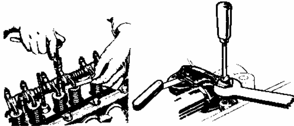
Figura 26- Afinação das válvulas de um motor com válvulas à cabeça Fonte: CNEEMA (1976)
